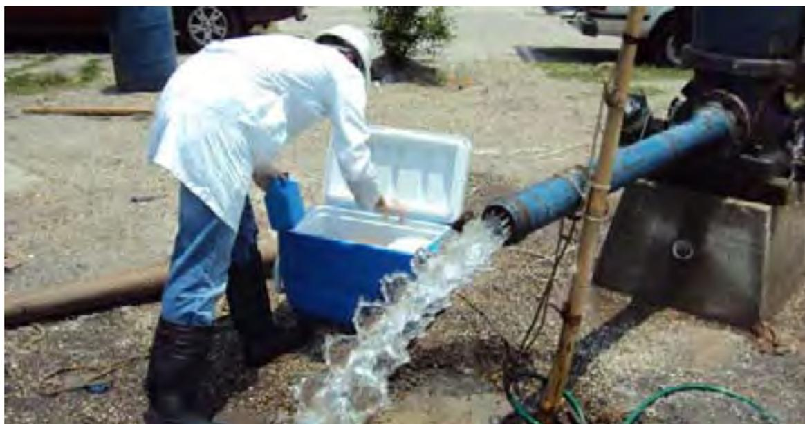
**Muestra de análisis físico-químico del pozo perforado "Hacienda de las Casillas" en el Municipio de Jiutepec.**
